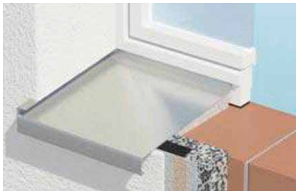
Afb. 36: aansluitingsdetail met zweband
