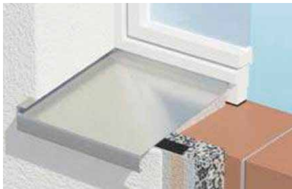
Afb. 38: aansluitingsdetail met zweiband
