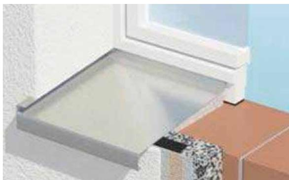
**Fig. 38 :** Exécution des détails avec bande d'étanchéité
