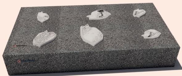
L'**absence de collage sur le pourtour** du panneau permet une circulation d'air derrière le panneau d'isolation.
