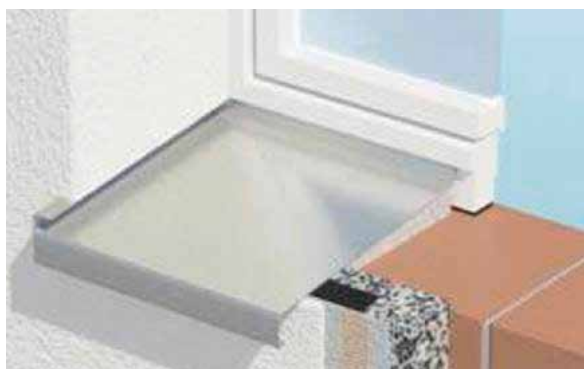
Fig. 38 : Exécution des détails avec bande d'étanchéité
