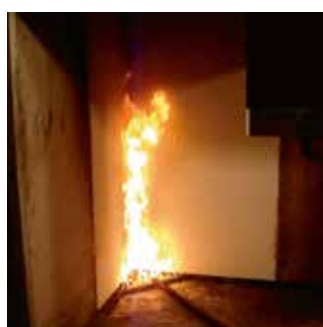
Fig. 26 : Essai de réaction au feu
